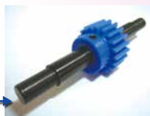
将正齿轮套在轴上。(方向无关。)
