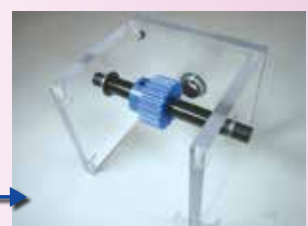
在框架上安装齿轮轴。
