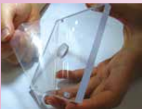
揭去所有框架板的保护膜。
